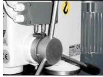
Cod. 18080: Gewindeschneideeinrichtung mit Drehrichtungswender.
