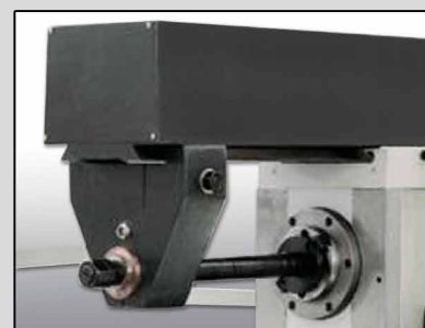
Lunetta di sostegno albero orizzontale. Lunetta pour arbre horizontal. Horizontal shaft support. Soporte de eje horizontal.
