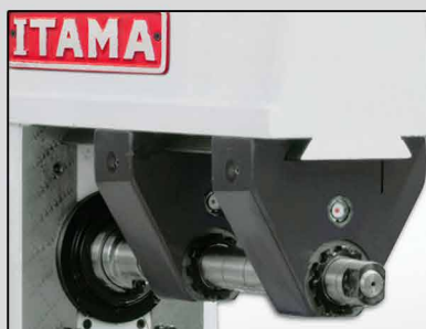
Lunette di sostegno albero orizzontale. Lunettes pour arbre horizontal. Horizontal shaft supports. Soportes de eje horizontal.
