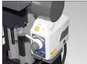
Code 40026 Power: Automatisch-mechanische Tischlängenverstellung
