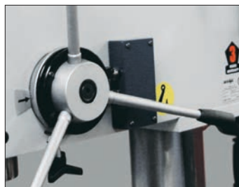
Cod. 40002: Gewindeschneideeinrichtung mit Drehrichtungswechsel
